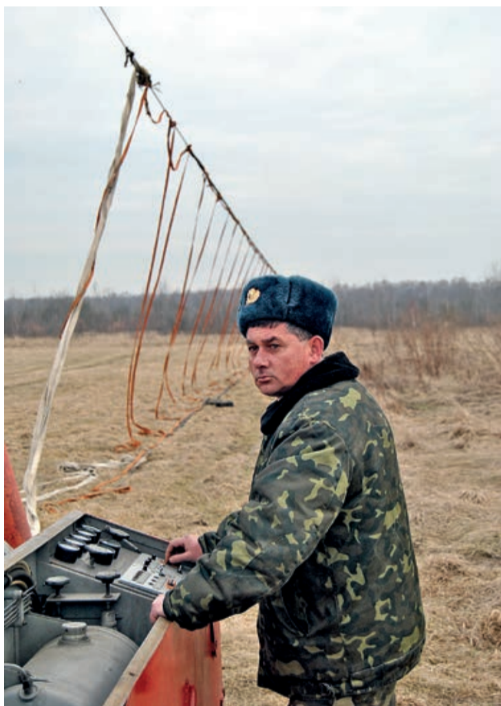
OPERATOR ATU PRZY PRACY. LINY NA TYLNYM PLANIE MAJĄ „ZŁAPAĆ” SAMOLOTA POZA PASEM STARTOWYM
